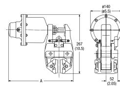
(With new pads) Caliper MX13 295.5 (11.6) MX25 302.0 (11.9) MX30 301.5 (11.9) MX40 310.0 (12.2) For XSH9.6 add 25mm (1.0)
